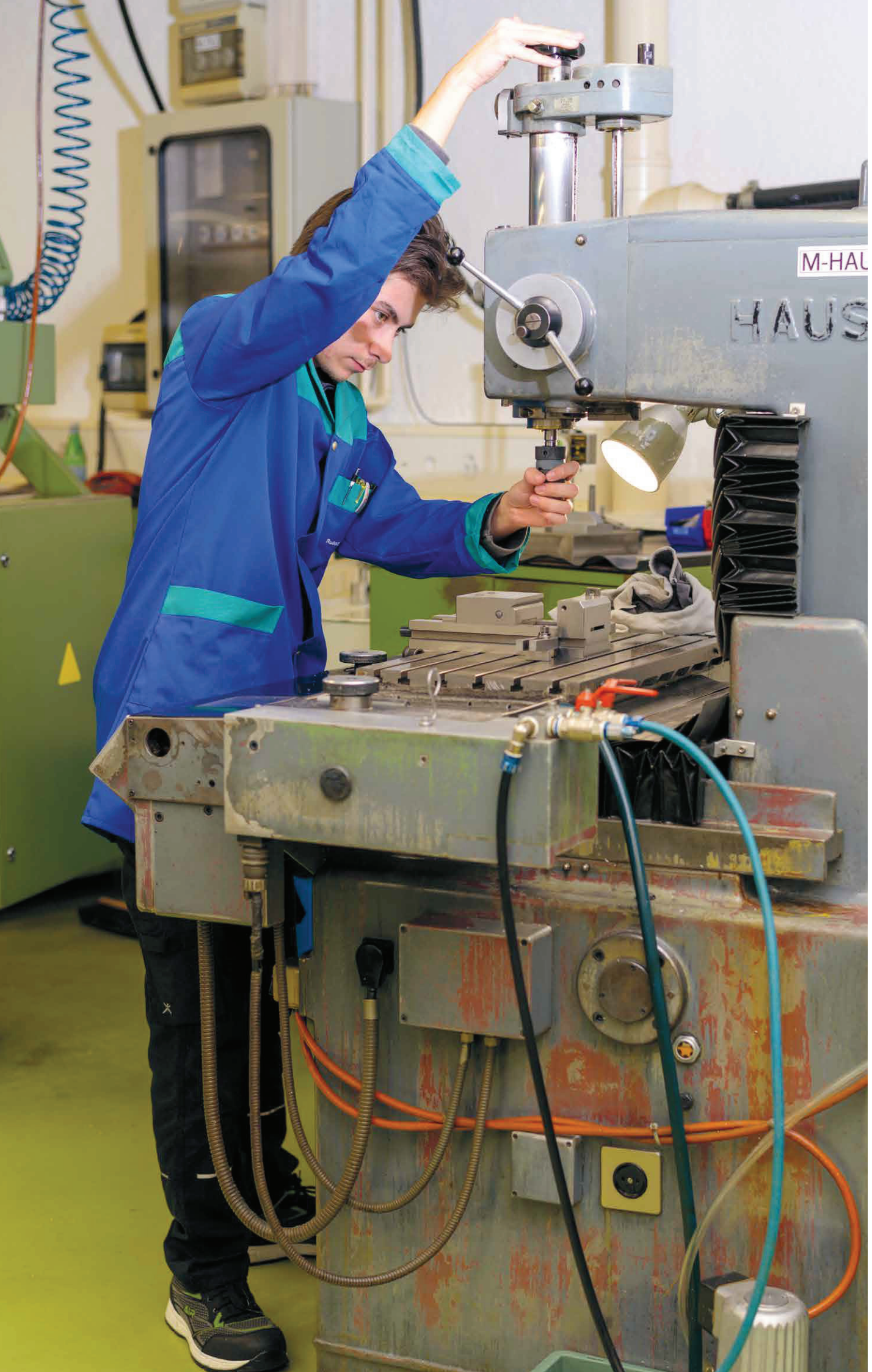
Leandro Fresta tauscht an der Bohrmaschine den Bohrer aus.
